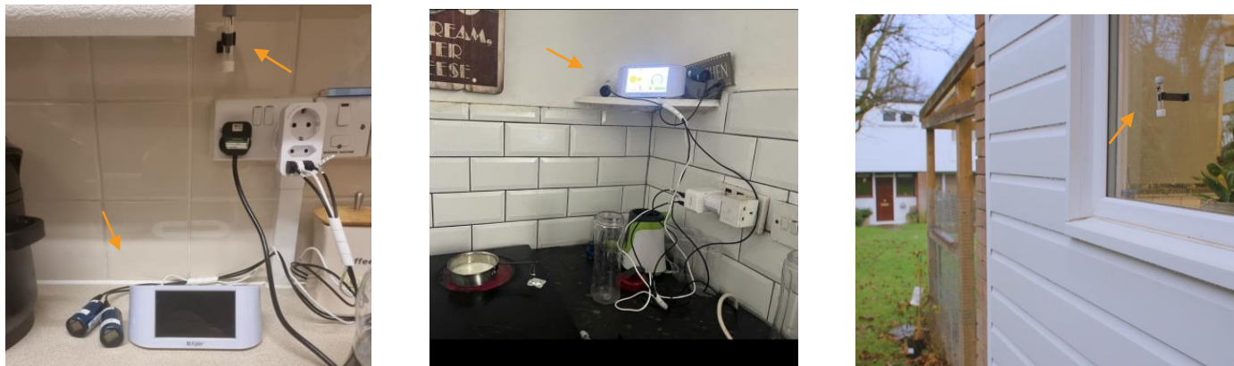
FIGURA 4. AMPLASAREA TIPICĂ A SENZORILOR DE \text{NO}_2 ȘI \text{CO} , A SENZORULUI DE \text{PM}_{2.5}/\text{CO}_2 ȘI A SENZORILOR PASIVI DE \text{NO}_2 .
