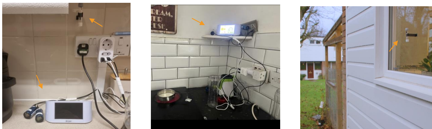
FIGUUR 4. TYPISCHE PLAATSIING VAN DE NO 2 - EN CO-SENSOREN, DE PM 2,5 /CO 2 -SENSOR EN DE PASSIEVE NO 2 -SENSOREN.
