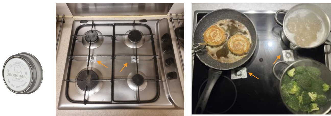
FIGUUR 3. GEBRUIK VAN IBUTTONS OP HET FORNUIS EN DE OVEN
