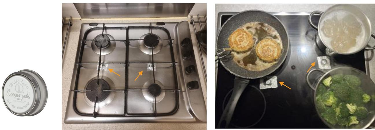
[iButton DS1922-L](#) è il sensore applicato sul piano cottura per monitorare l'uso dei fornelli e del forno a gas. *iButton rileva l'orario e la temperatura per identificare il momento in cui la famiglia cucina. Sono stati collocati due sensori sul piano cottura a gas o elettrico e uno sul forno a gas.*
