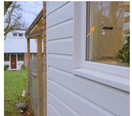
Die passiven  $\text{NO}_2$ -Sensoren wurden an eine Wand in der Küche (s. o. im ersten Bild) und in anderen Räumen des Hauses sowie an eine Wand oder Fläche im Freien geklebt, idealerweise außen vor der Küche und nicht neben einem Lüftungsschacht, wie im Bild rechts zu sehen. Die anderen Sensoren wurden in der Küche in einem Abstand von 1 bis 3 Metern zum Kochbereich (aber nicht darüber oder darunter) und nicht in der Nähe eines offenen Fensters oder einer Tür angebracht.
