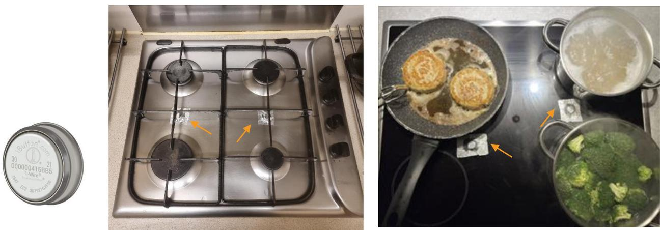
Ein Sensor zur Überwachung der Herdnutzung: Der [iButton DS1922-L](#) wurde verwendet, um die Nutzung von Herd und Gasbackofen zu erfassen. Der iButton überwacht Zeit und Temperatur, um
