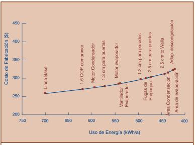
Figura 6-5 Ejemplo de datos importantes para un análisis de ingeniería: un refrigerador-congelador con puerta superior y descongelación automática
