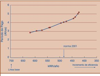
Figura 6-7 Los períodos de pago para refrigeradores-congeladores de deshielo automático de montaje superior
