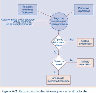
Figura 6-2 Esquema de decisiones para el método de análisis de las normas para aparatos
